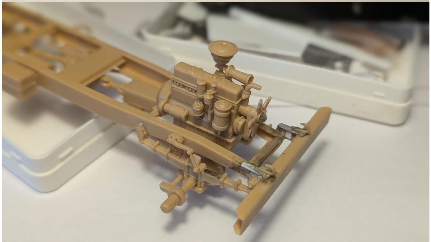
J'ai rajouté des languettes en carte plastique, pour renforcer la fixation des crochets.
