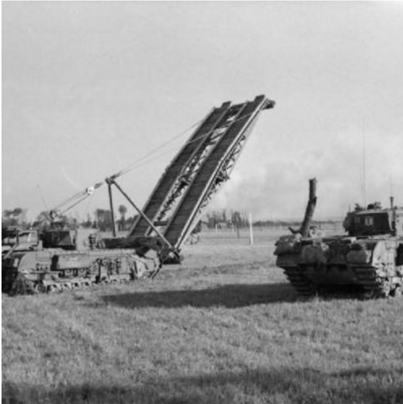
Small Box Girder : Le Small Box Girder était un char qui pouvait déployer un pont d'assaut de 10 m 2 pour permettre le franchissement d'un large fossé tout en assurant une couverture à son équipage. La capacité de charge était de 40 tonnes
